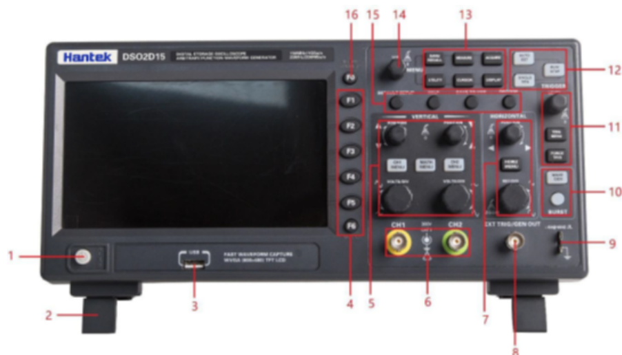
Figura 1: Esquema do painel frontal do osciloscópio
