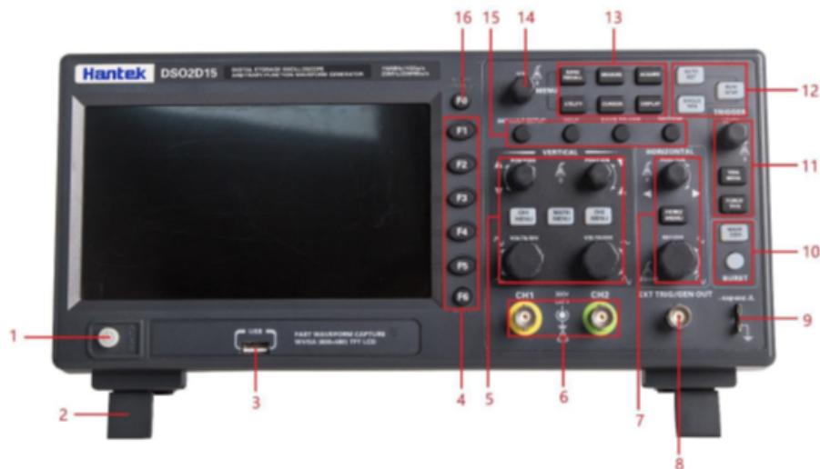
Figura 2: Esquema do painel frontal do osciloscópio
